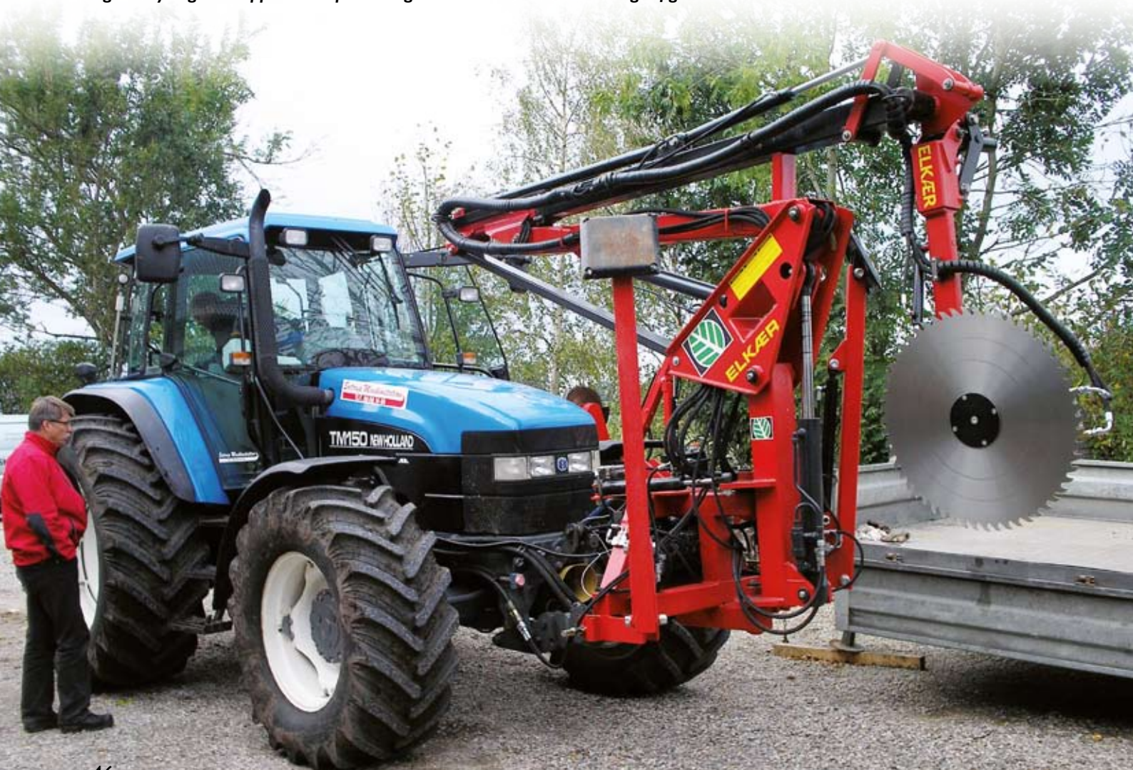
Figur 4 Pyntegrøntklipper i transportstilling. Bemærk støttebenene - se også figur 3.
