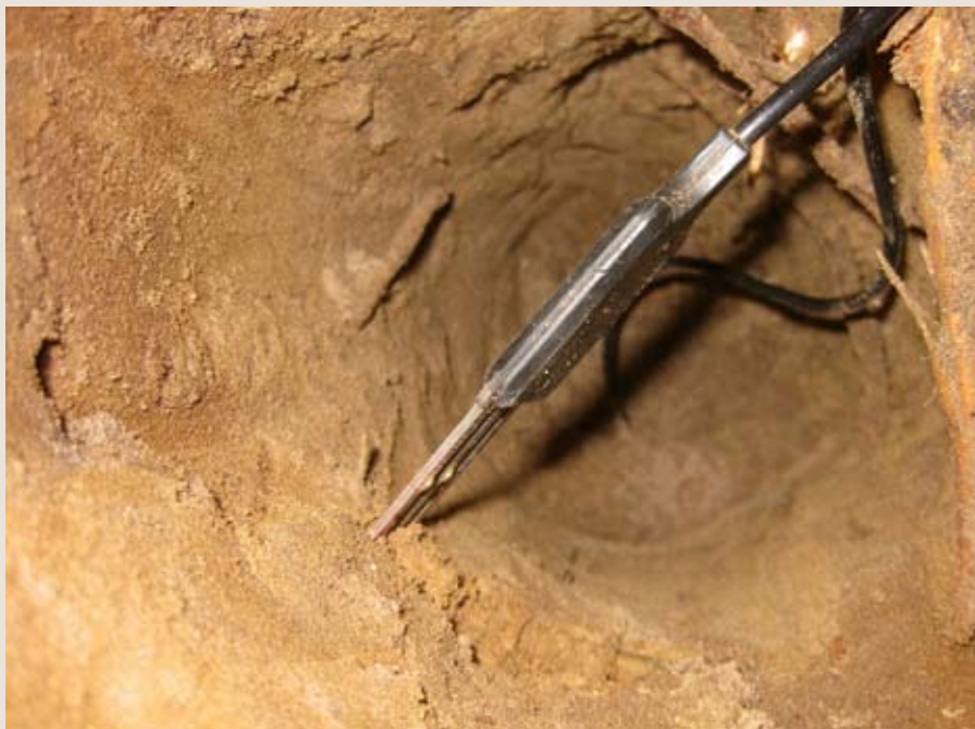
Foto 2. Sensor og installation af sensor i jordhul. Jordhullet graves nænsomt med en pælespade og jorden hældes forsigtigt lagvis i igen efter installationen af sensoren i hullets sidevæg. Foto: Lars Bo Pedersen
