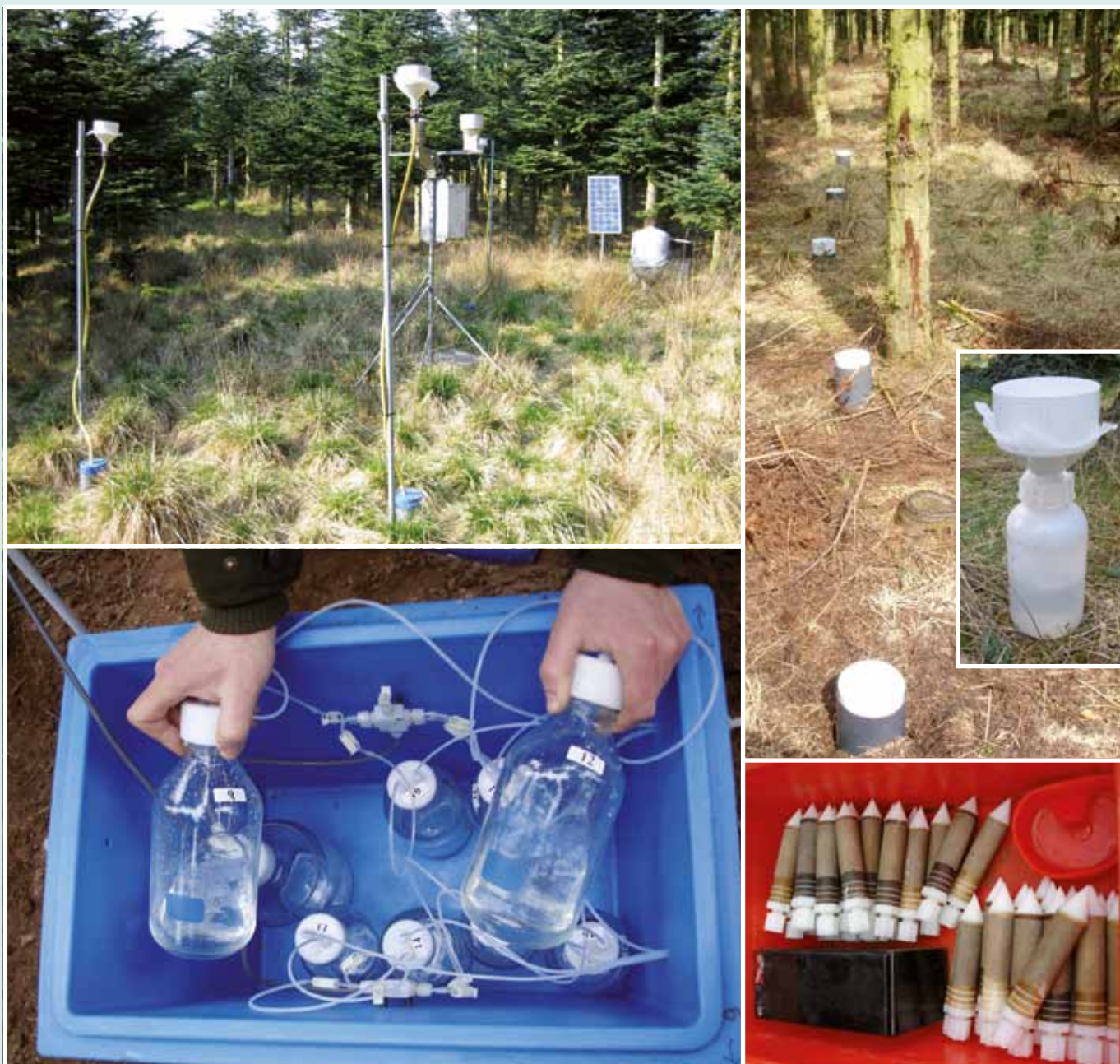
Figur 3. Instrumentering i forsøgene. Øverst til venstre to nedbørstragte med tilhørende nedgravede opsamlingsbeholdere (nedbøren skal holdes kold af hensyn til de kemiske målinger). Man ser også en klimastation, hvor der udoover nedbør måles indstråling, relativ luftfugtighed og lufttemperatur. I baggrunden ses et solpanel der driver et pumpesystem, som suger jordvand ud af jorden. Nederst til venstre en nedgravet plastkasse med flasker der indeholder indsuget jordvand. Jordvandet suges ind igennem nedgravede porøse sonder, nederst til højre. Øverst til højre ses en række tragte med nedgravede opsamlingsflasker. Disse bruges til at indsamle prøver af kronegennemdryp. Foto: Lars Bo Pedersen.
