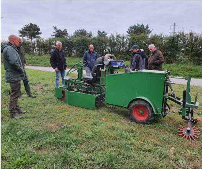
Rulleharven i den afprøvede en-rækkede udgave. Rulleharven fås også til portaltraktor.
