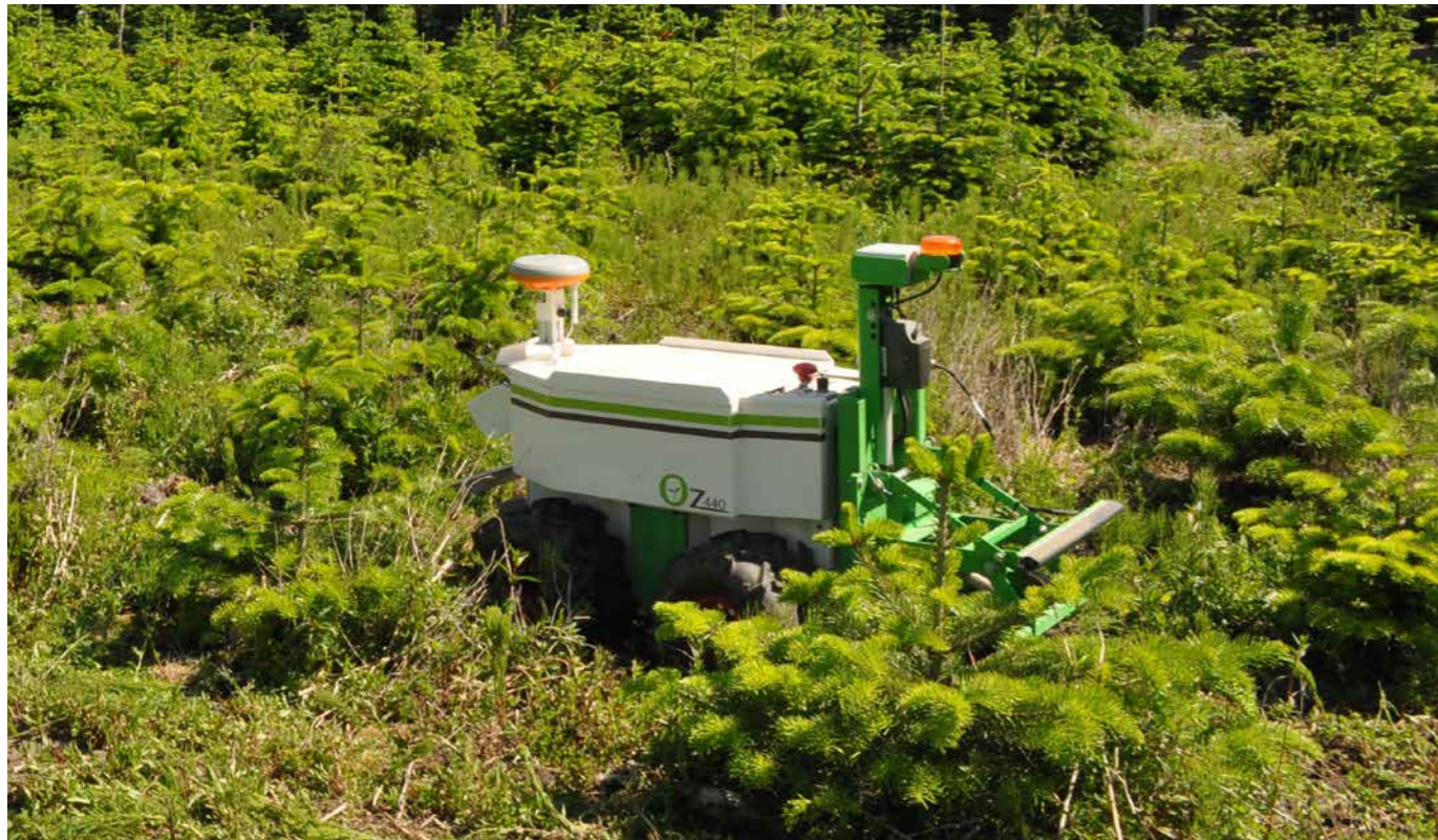
OZ: Til nyetablerede kulturer, hvor der kan radrenses meget tæt på det lille træ uden at beskadige dette. Marken skal være uden store stigninger, og jorden skal være rodfræset. OZ har en motorkraft på 0,7 kW og kan klare lette monterede redskaber bagerst.
