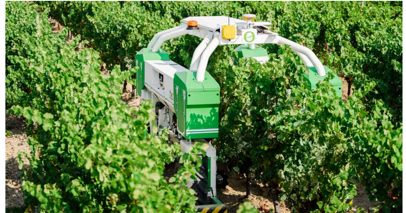
TED: En meget robust og effektiv portalrobot med betydelig trækraft, der kan klare det meste, herunder også meget stenet jord. TED kan ikke køre på marker med en stigning over 10%, og kan have svært ved at komme helt ind under juletræerne. Denne model kan muligvis være rigtig god til store juletræer, men det er endnu ikke testet.
