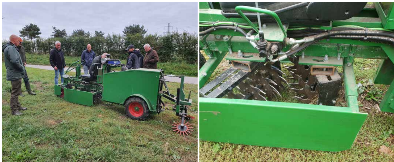
Rulleharven i den afprøvede en-rækkede udgave. Rulleharven fås også til portaltraktor.
