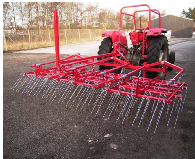
Langfingerharve monteret efter traktor. Langfingerharven kan fås i flere arbejdsbredder.
