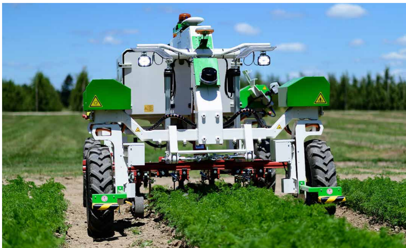
ORIO: En robot med en arbejdsbredde mellem 1,60 og 2,25 meter. Den kan spænde over flere rækker, og er yderst effektiv i arbejdet med radrensning. ORIO kan også så afgrøder, der står på række via en fem- eller seksradet såmaskine. Der kan monteres redskaber, oftest redskaber der allerede står i maskinhuset. Velegnet til planteskoler og småplanter.
