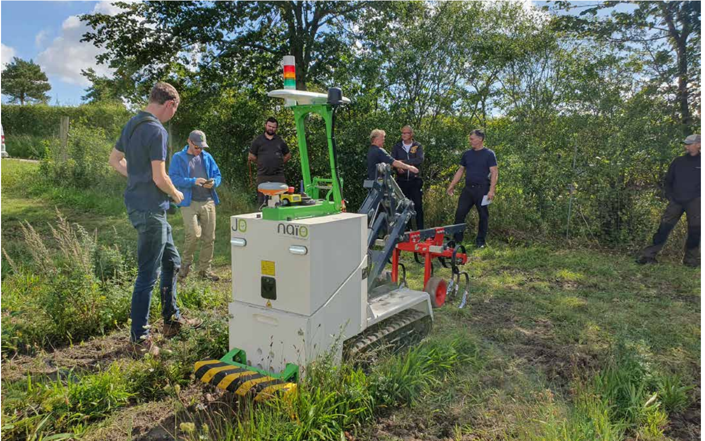
JO: Til nyetablerede kulturer. Klarer større stigninger på marken og kommer fint ukrudtet til livs. Har en betydelig større kapacitet end OZ, men kræver også mere plads, og lidt større bredde i rækkerne, for at komme rundt i kulturen. Kører i rækkerne og ikke hen over planterne (se evt. video på Danske Juletræers Youtubekanal).
